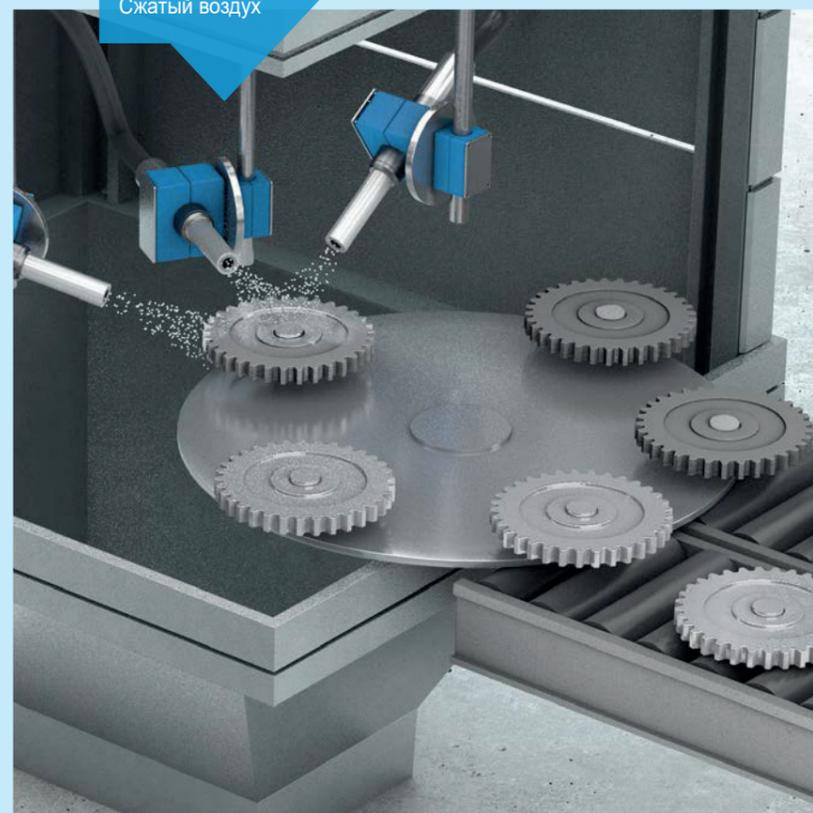
Внизу: частичный наклеп зубчатых колес
